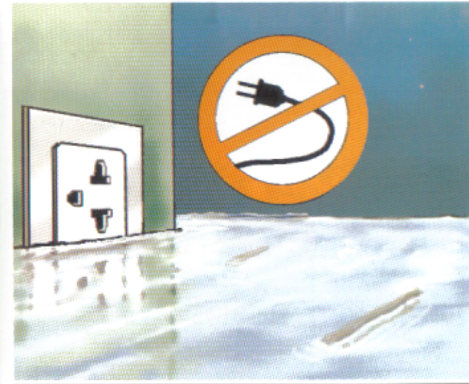
5. ปลั๊กไฟฟ้าที่มีน้ำท่วม ห้ามใช้งาน โดยเด็ดขาด
