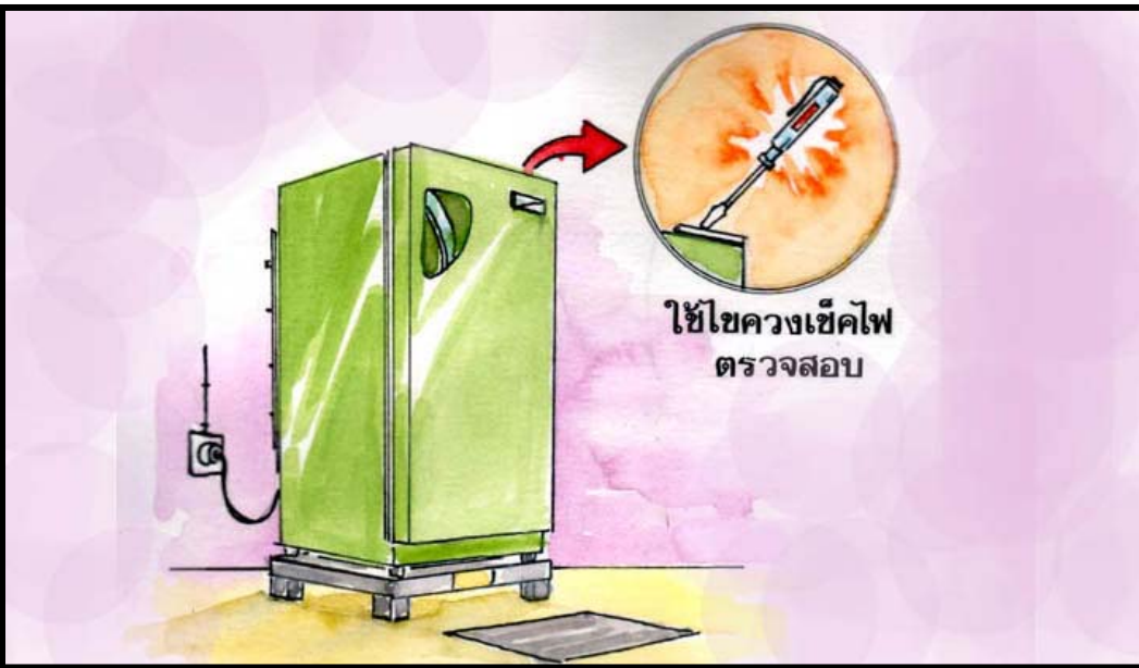
ใช้ไขควงเช็คไฟตรวจสอบตู้เย็นหรือตู้แช่ว่ามีกระแสไฟฟ้ารั่ว หรือไม่ โครงโลหะตู้เย็น ควรมีการต่อสายลงดิน
