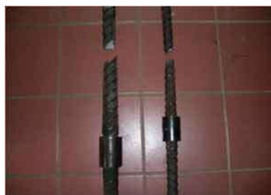
รูปที่ 4.75 ทดสอบการดึงเหล็ก แสดงถึงความแข็งแรงบริเวณจุดต่อโดยวิธี Coupler เหล็กจะขาดบริเวณที่ไม่ใช่รอยต่อ
