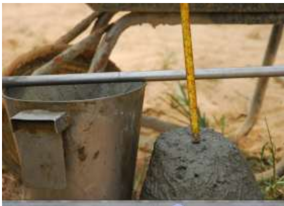
รูปที่ 4.122 ตรวจสอบ Slump ก่อนอนุญาตให้เทคอนกรีต
