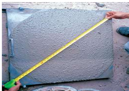
รูปที่ 4.71 การทดสอบ Slump Self-Compacting Concrete เป็นคอนกรีตที่สามารถไหลซอกซอนเข้าไปในช่องแคบของแบบหล่อได้ ซึ่งสามารถแก้ปัญหาในเสาเข็มที่มีเหล็กแน่น จะไม่วัดความสูงคอนกรีตแต่วัดความกว้างของคอนกรีตที่กระจายตัว
