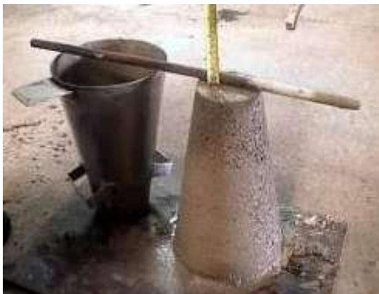
รูปที่ 4.64 การเช็ค Slump คอนกรีต ก่อนอนุญาตให้เทลงในแบบหล่อ
